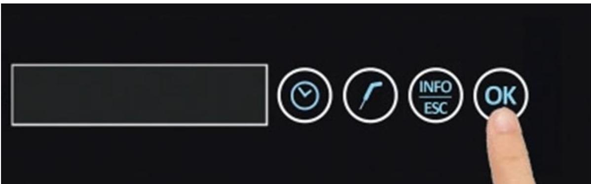
Nach dem Drücken der Taste „BESTÄTIGUNG“ kann die Temperatur im inneren des Geräts eingestellt werden.
