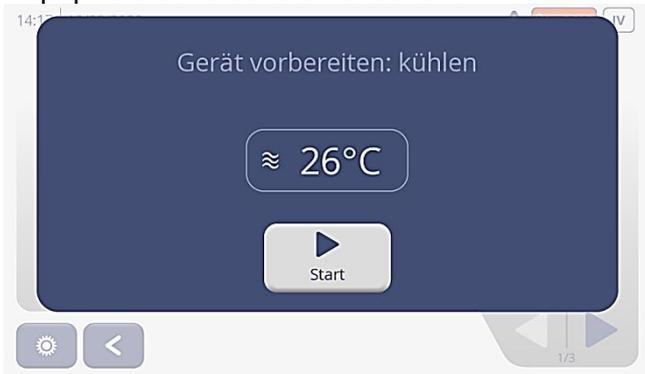
Auf dem Display wird die Innenraumtemperatur vom Gerät angezeigt. Hat diese den eingestellten Sollwert von -30°C erreicht, erscheint das Popup Fenster: Gerät vorgekühlt.
