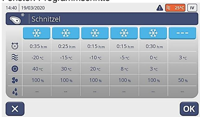
Nun kann jeder Schritt in dem Programm individuell angepasst werden indem Sie die oberen hellblauen oder roten Tasten mit dem Kühl-/Frost- oder Heizsymbol drücken.
