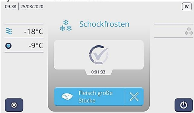
Am Ende des Zyklus erscheint der Popup: Zyklusende mit den HACCP Daten. Das Gerät läuft im Lagermodus bei einer Raumtemperatur von -18°C.
