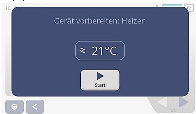
Auf dem Display wird die Innenraumtemperatur vom Gerät angezeigt und hat diese den eingestellten Sollwert von 60°C erreicht öffnet sich das Popup „Gerät vorbereitet“.
