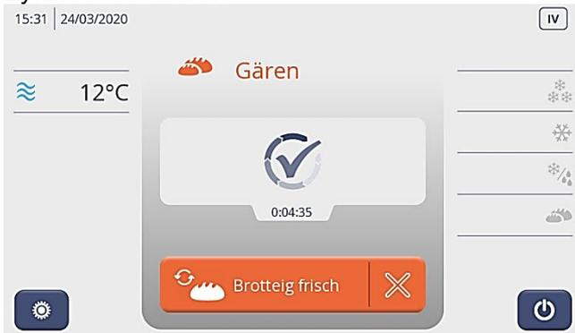
Am Ende des Zyklus erscheint der Popup: Zyklusende mit den HACCP Daten. Das Gerät läuft im Lagermodus bei der eingestellten Raumtemperatur.
