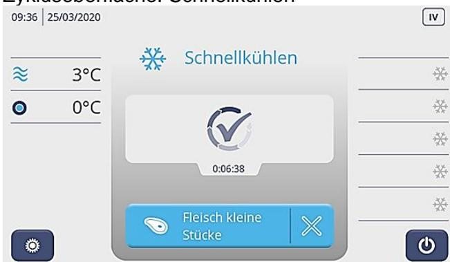
Am Ende des Zyklus erscheint ein Popup „Zyklusende“ mit den HACCP Daten und das Gerät läuft im Lagermodus bei einer Raumtemperatur von + 3°C.
