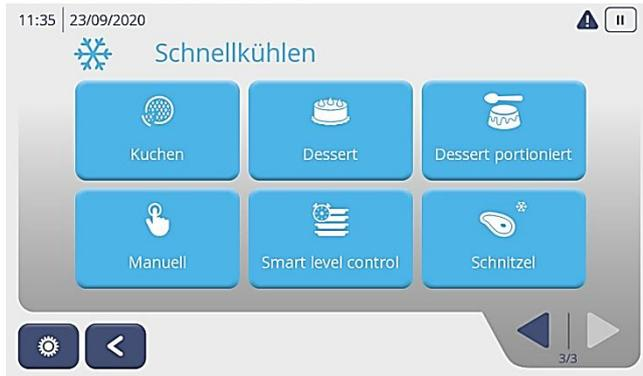
Drücken Sie in der Produktauswahlliste die Taste von dem Programm, welches Sie löschen wollen für 5 Sekunden. Z.B. Schnitzel.
