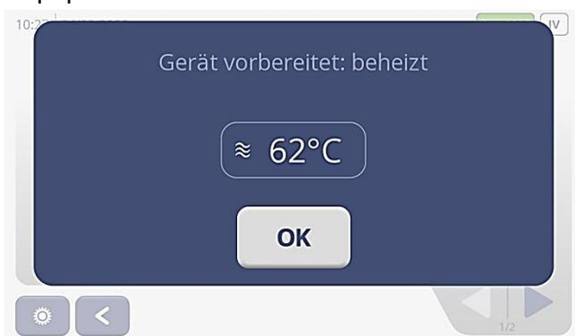
Drücken Sie nun auf „OK“, erscheint im Display die Produktauswahl mit den entsprechenden voreingestellten Rezepten zum NT-Garen der verschiedenen Produkte und einer manuellen Funktion sowie der Smart Level Control Funktion.
