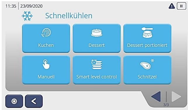
Drücken Sie in der Produktauswahlliste die Taste von dem Programm welches Sie verschieben wollen für 5 Sekunden. Z.B. Schnitzel.
