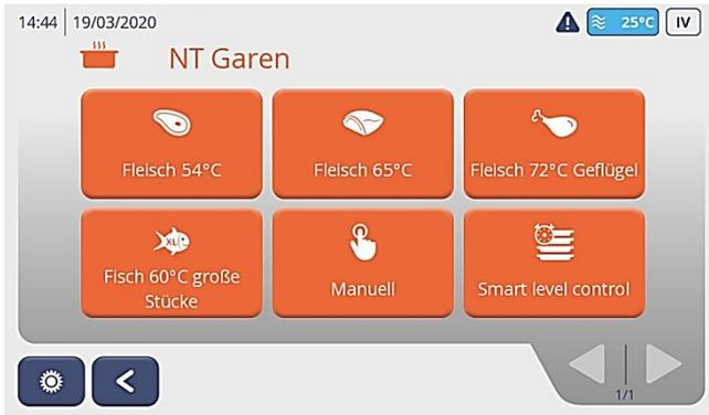
Mit der Pfeiltaste unten rechts Produktauswahl durchblättern und ausgewähltes Produkt durch Drücken der Taste auswählen.
