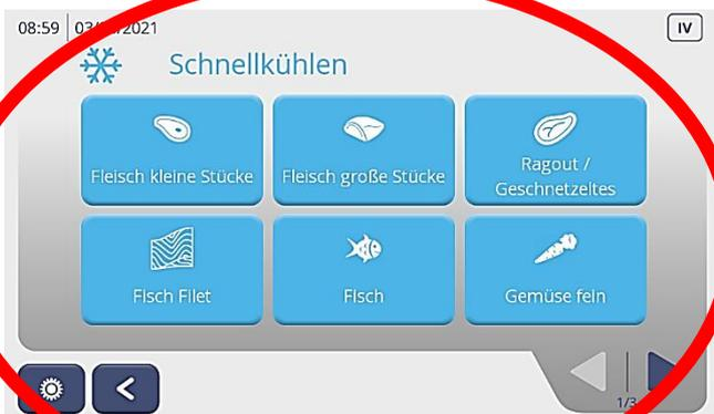
Mit der Pfeiltaste unten rechts, Produktauswahl durch Blättern. Durch Tastendruck das zu kühlende Produkt auswählen.
