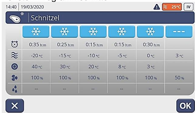
Jetzt kann jeder Schritt in dem Programm individuell angepasst werden in dem Sie auf die oberen hellblauen oder roten Tasten mit dem Kühl-/Frost- oder Heizsymbol drücken.
