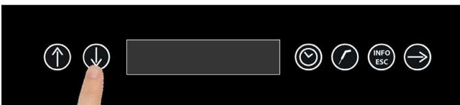
Avec les touches flèches HAUT et BAS sélectionner le cycle **-20°C**.
