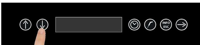
Avec les touches flèches HAUT et BAS sélectionner le cycle +3°C.
