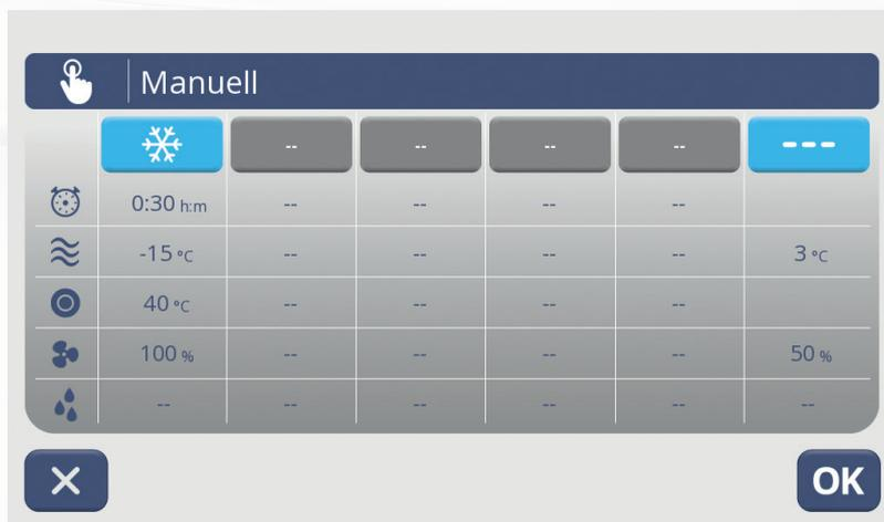
❄ Sowohl VINTOS als auch VINTOS+ bieten die Möglichkeit, manuelle, genau auf den Bedarf abgestimmte Programme zu erstellen. Die Handhabung ist denkbar einfach und ermöglicht es, Zeit, Temperatur und Lüfter-Geschwindigkeit individuell einzustellen. The VINTOS as well as the VINTOS+ offer the possibility, to manually generate customized programs for a specific cycle. The input is simple and allows for an individual setting of time, temperature and fan speed.
