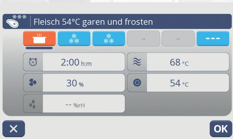
❄️ Kombinierte Programme bieten ein Höchstmaß an Komfort und Zeitersparnis. Speisen können damit auch nach Feierabend z. B. NT-gegart und anschließend automatisch schnellgekühlt oder schockgefrostet werden. Das bedeutet nicht nur mehr Flexibilität für die Mitarbeiter sondern auch maximale Lebensmittelhygiene.
